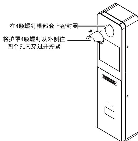
图3-4 遮阳罩安装示意图
